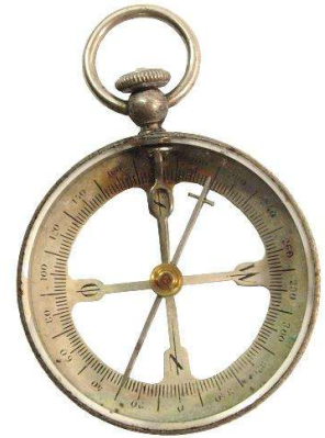
K. S. Stockert ca. 1915 Remontoirarretierung und Balkennadel
