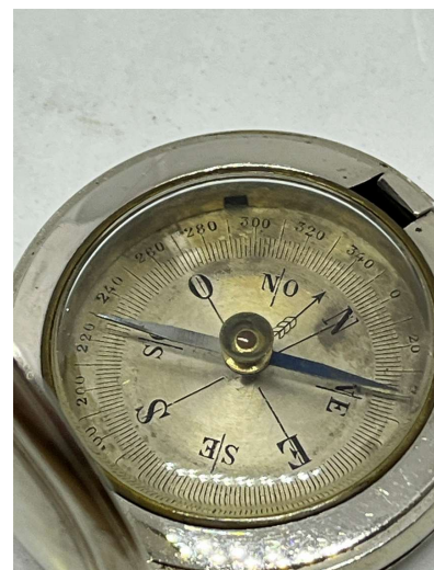
Deklinationskorrektur 20 Grad WEST
