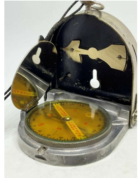
Patent Bézard mit ursprünglicher Skala
