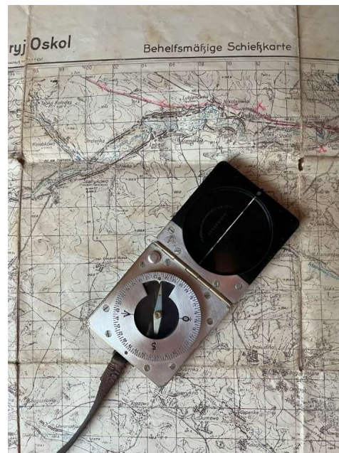
Ermitteln der Marschrichtung bzw der Schiessrichtung auf einer behelfsmässigen Schießkarte der 1940er Jahre
