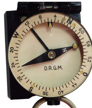
Skala 64-00 Strich linksdrehend mit D.R.G.M.
