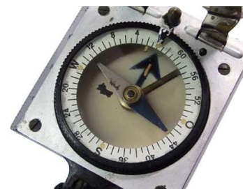
Skala 64-00 Strich linksdrehend mit nachtleuchtendem Marschrichtungspfeil
