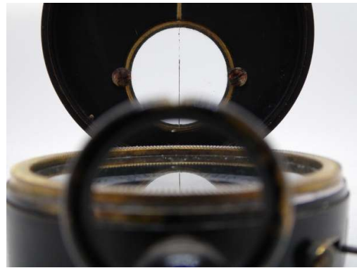
Der Daumenring mit einer Kerbe als Peilhilfe
