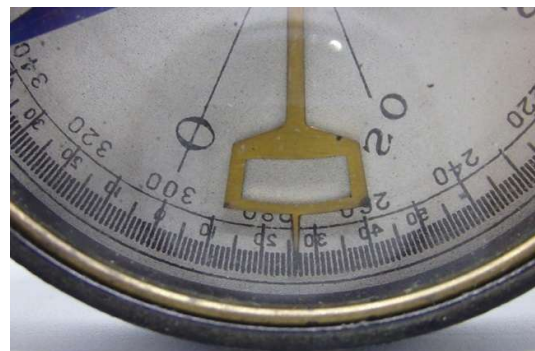
Neigungsmesser in die Skala integriert
