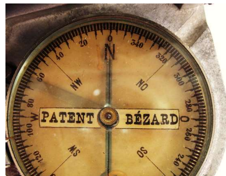
Skala 360 Grad linksdrehend
