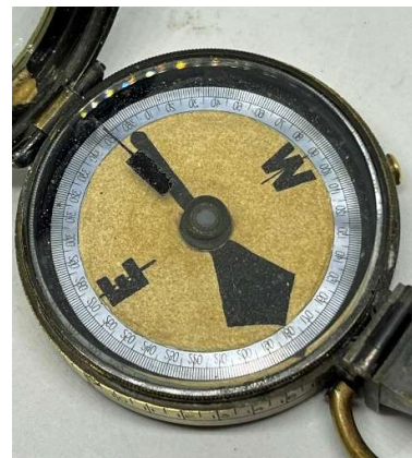
Skala für die Ablesung in 360 Grad
