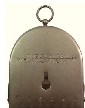
Gehäusedeckel mit Marschrichtungspfeil
