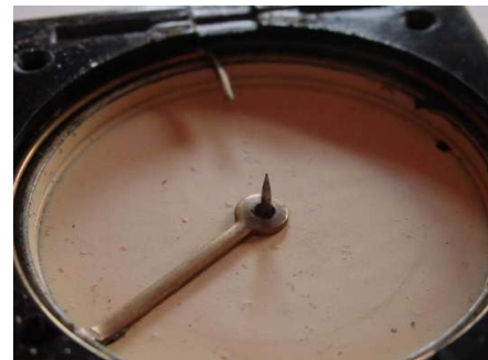
Gehäuseboden mit Pinne und verstellbarem Deklinationsstift
