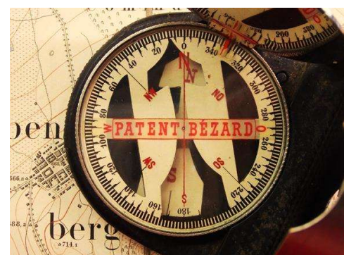
Skala 360 Grad linksdrehend
