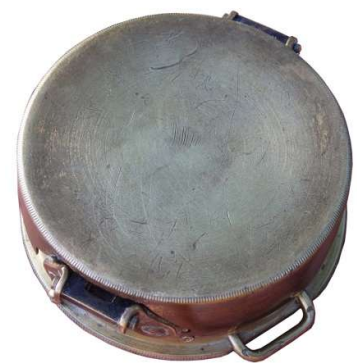
Messingdeckel schützt die Skala
