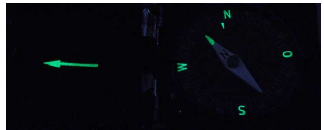
Nachleuchtende Himmelsrichtungen und Marschrichtungspfeil
