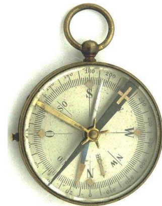
Marschkompass mit einer Direktionslinie
