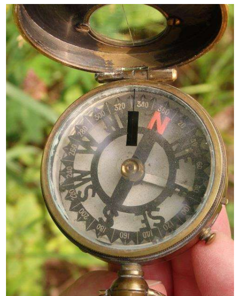
Skala 360 Grad rechtsdrehend „Skeleton Dial“
