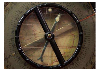
Deklinationskorrektur links neben der Nordmarkierung auf den transparenten Kapseldeckel
