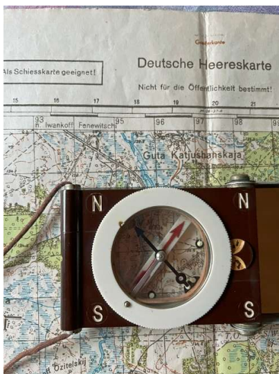
Ermittels der Marschrichtung oder der Richtung zum Ziel aus der Karte
