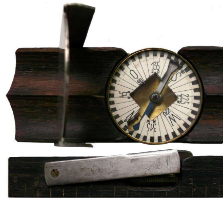
Urmodell der Winterer Bussole, Ablesung ähnlich dem Bézard-Kompass „Großes Armee Modell 1910“
