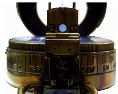
Anvisieren über Prisma und Visierstrich
