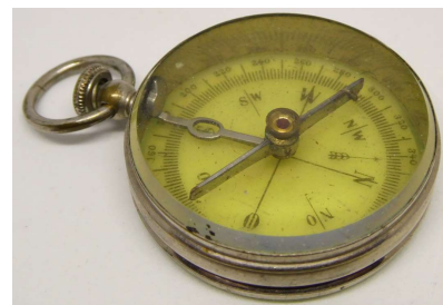
Kartenkompass mit einer Remontoirarretierung
