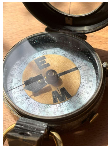
Ost- und Westmarkierung ist markanter als bei Vorgängermodell Mk V
