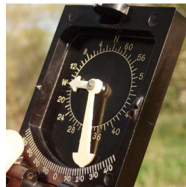
Kippen des Deckels und Ablesen des Steigung
