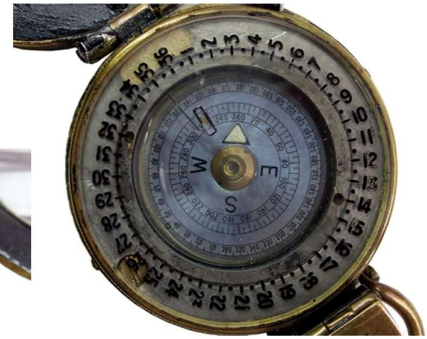
Skala und äußerer Teilring des Mk III
