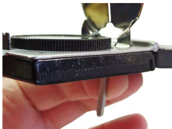
Haltemechanismus des Marschkompasses I Patent 1936 – D.R.P.
