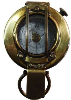
Ablesung bei geschlossenem Deckel
