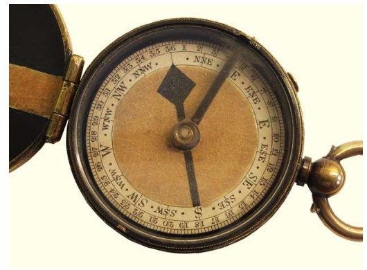
Skala 360 Grad rechtsdrehend jeder 10te Grad numerisch gekennzeichnet, jeder 2te mit einem Strich markiert
