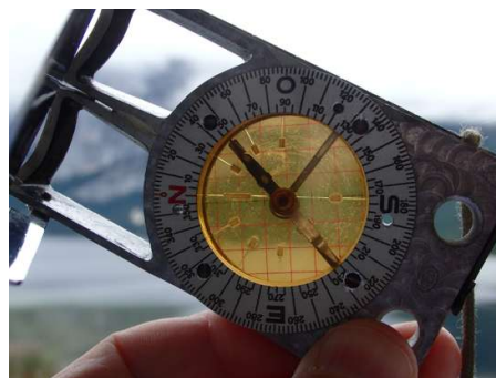
Winterer Bussole bei Messen von Höhenwinkeln
