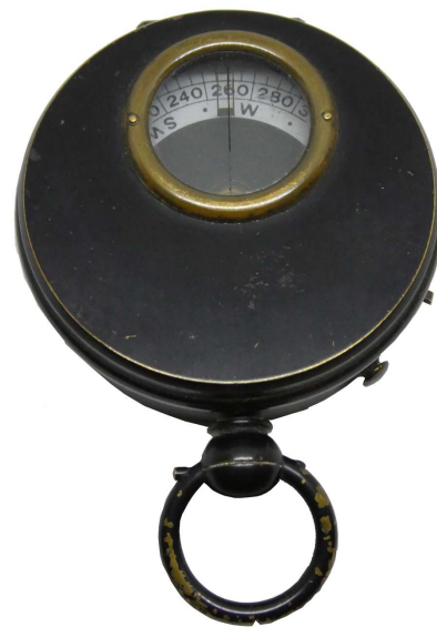
Ablesemöglichkeit bei geschlossenem Deckel
