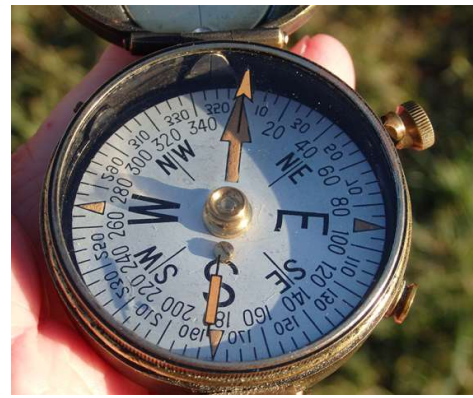
Skala mit radiumhaltigem Leuchtmittel
