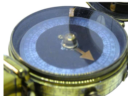
Kompassrose aus Permutt
