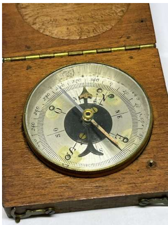
Skala mit radioaktiven Markierungen
