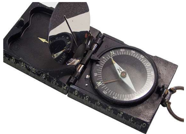
Marschkompass aus Elektron aus dem Jahre 1940
