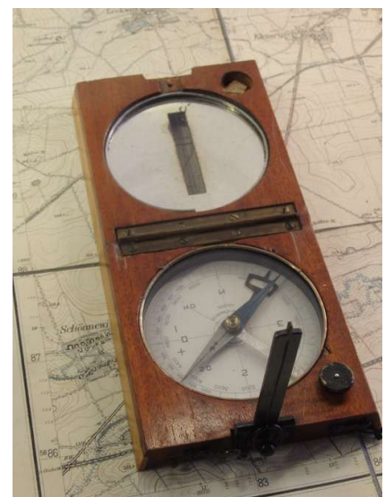
Einnorden der Karte an der Meridianlinie (Magnetnadel funktioniert leider nicht mehr)
