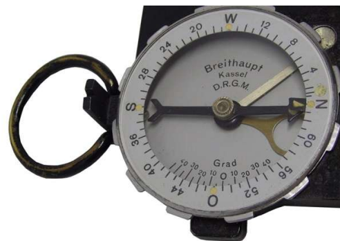
Kompass-Skala 64-00 Strich linksdrehend
