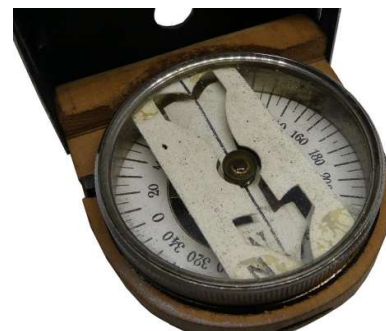
rechtsdrehende Skala in 360 Grad
