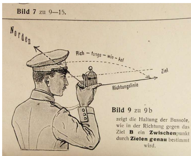
Anschauliche Darstellung des Zielvorganges
