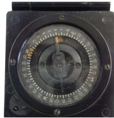
Skala 360 Grad rechtsdrehend
