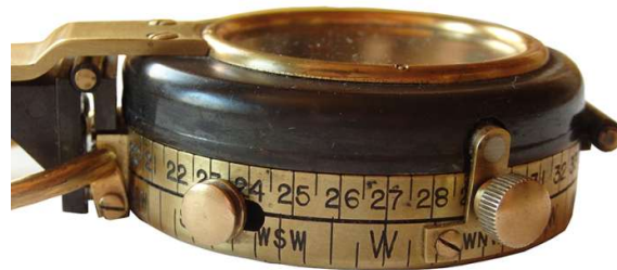
Seitliche Skala mit Arretiermechanismus der Perlmutscheibe
