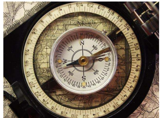
Skala 64-00 Strich rechts- und linksdrehend
