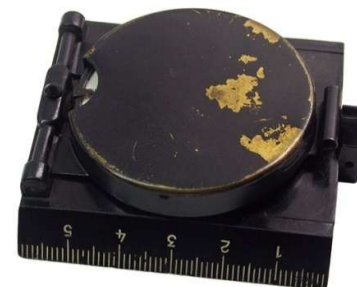
Metallspiegel mit Anlegekante
