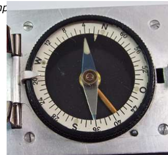
Skala des Touristenkompasses mit Stabilisationsring
