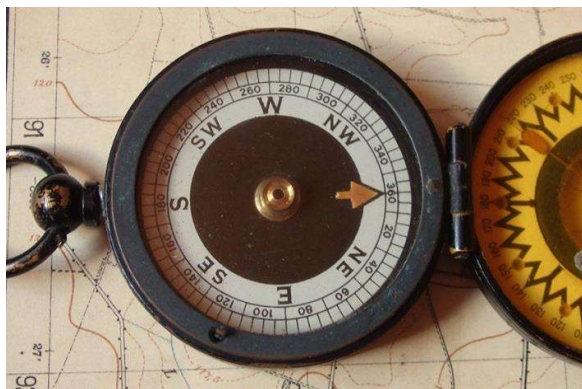
Skala 360 Grad rechtsdrehend
