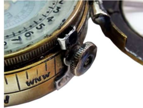
Skala und äußerer Teilring des Mk III
