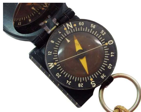
Skala 64-00 Strich linksdrehend Deklinationskorrektur bei 180 Strich WEST
