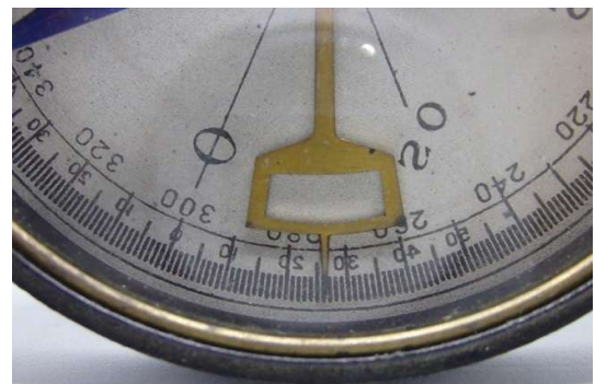
Neigungsmesser in die Skala integriert
