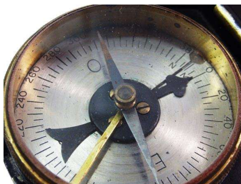
Gaumont Skala Modèle 1922 400 gon Skala
