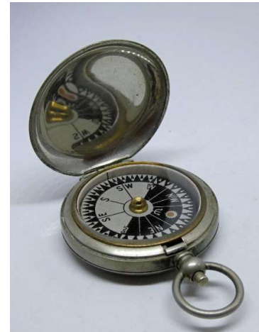
Skala nach Singer Patent mit radioaktiver Markierung
