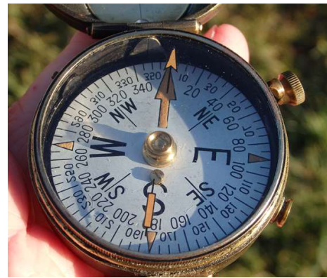
Skala mit radiumhaltigem Leuchtmittel
