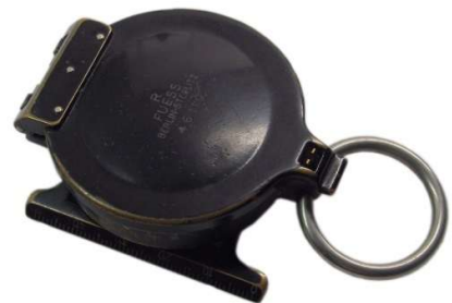
Armeemodell mit geschlossenem Deckel Marschkompass I
