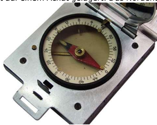
Skala linksdrehend in 64-00 Strich
