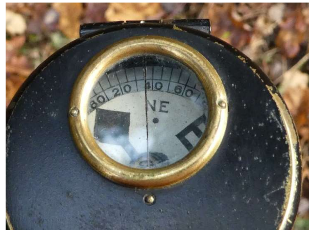
Ablesung über das Sichtfenster bei geschlossenem Deckel
