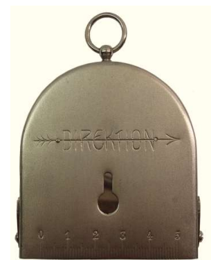
Gehäusedeckel mit Marschrichtungspfeil
