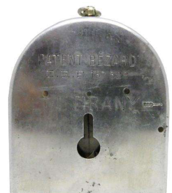
MENETIRÀNY (Marschrichtung) und ein kleiner Marschrichtungspfeil
