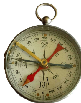
mit rotem Marschrichtungspfeil und Leuchtmarkierungen radioaktiv Quelle Bild Compassipedia
