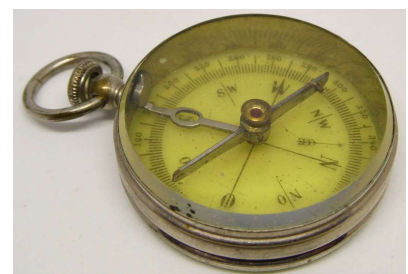
Kartenkompass mit einer Remontoirarretierung
