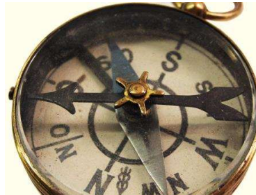
mit Marschrichtungspfeil statt der Direktionslinie
