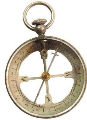
K. S. Stockert ca. 1915 Remontoirarretierung und Balkennadel
