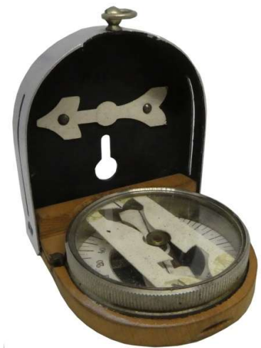
Diopterbussole aus dem Jahre 1905 nachleuchtend durch Balmainflüssigkeit
