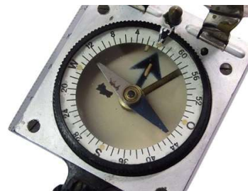
Skala 64-00 Strich linksdrehend mit nachtleuchtendem Marschrichtungspfeil
