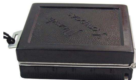
geschlossenes Gehäuse mit Anlegekante und Haltehebel
