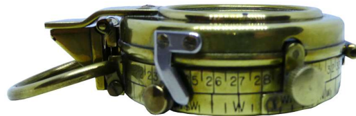
Arretierhebel des Kompassrose
