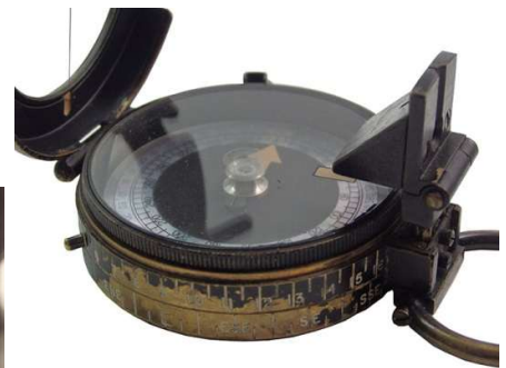
Prisma zur Ablesung der Skala
