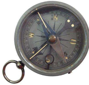
Taschenkompass mit Marschrichtungspfeil
