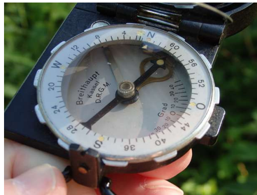
Ablezen des Azimuts
