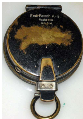
brüniertes Gehäuse mit gerändeltem Rand
