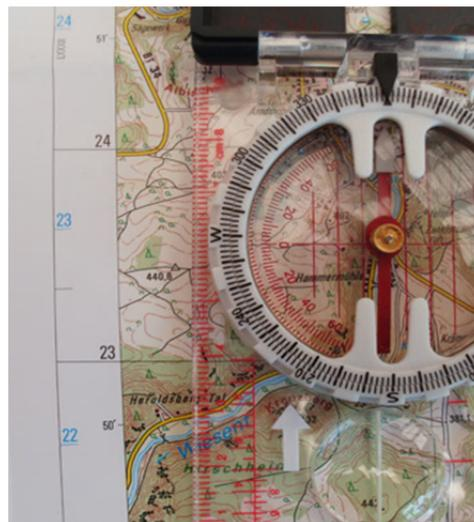
Anlegen eines Marschkompasses an ein Geodätisches Gitter
