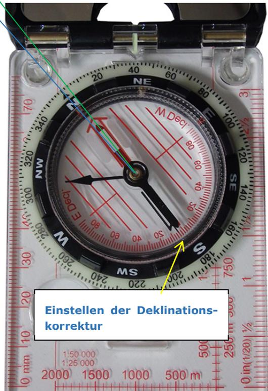
Nun wird nur noch die aus der Karte ermittelte Marschrichtung, hier im Beispiel sind es 41°, an der Ablesemarke eingestellt. Der Nordteill der Magnetnadel wird nun nicht auf die Nordmarkierung des Drehrings durch Drehen des ganzen Kompasses in Übereinstimmung gebracht, sondern mit der Nordmarkierung der Missweisung auf dem Kapselboden.
