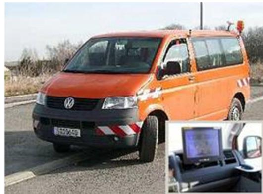
Außendienstfahrzeug der Topographen mit GPS-Antenne und Bildschirm zum Laptop (Foto: Achim Kern)
