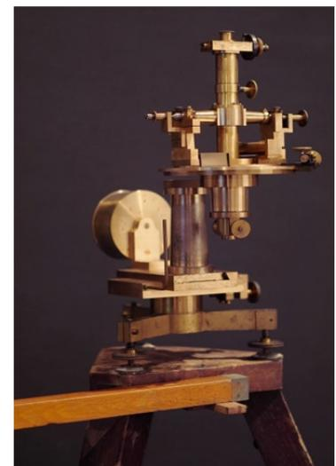
*Basisapparat zur Ausmessung von Basislatten*
